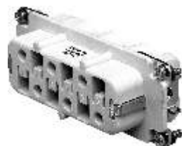
Miolo 35A Fêmea (380V) Contatos: prata passivada Ligação nos contatos até 6mm 2
